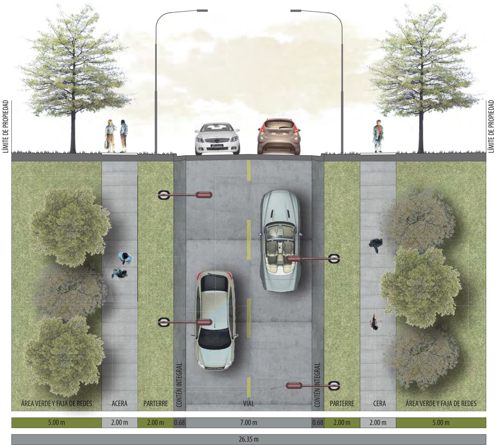
Figura 54. Viales Terciarios. Planta y sección vial.
