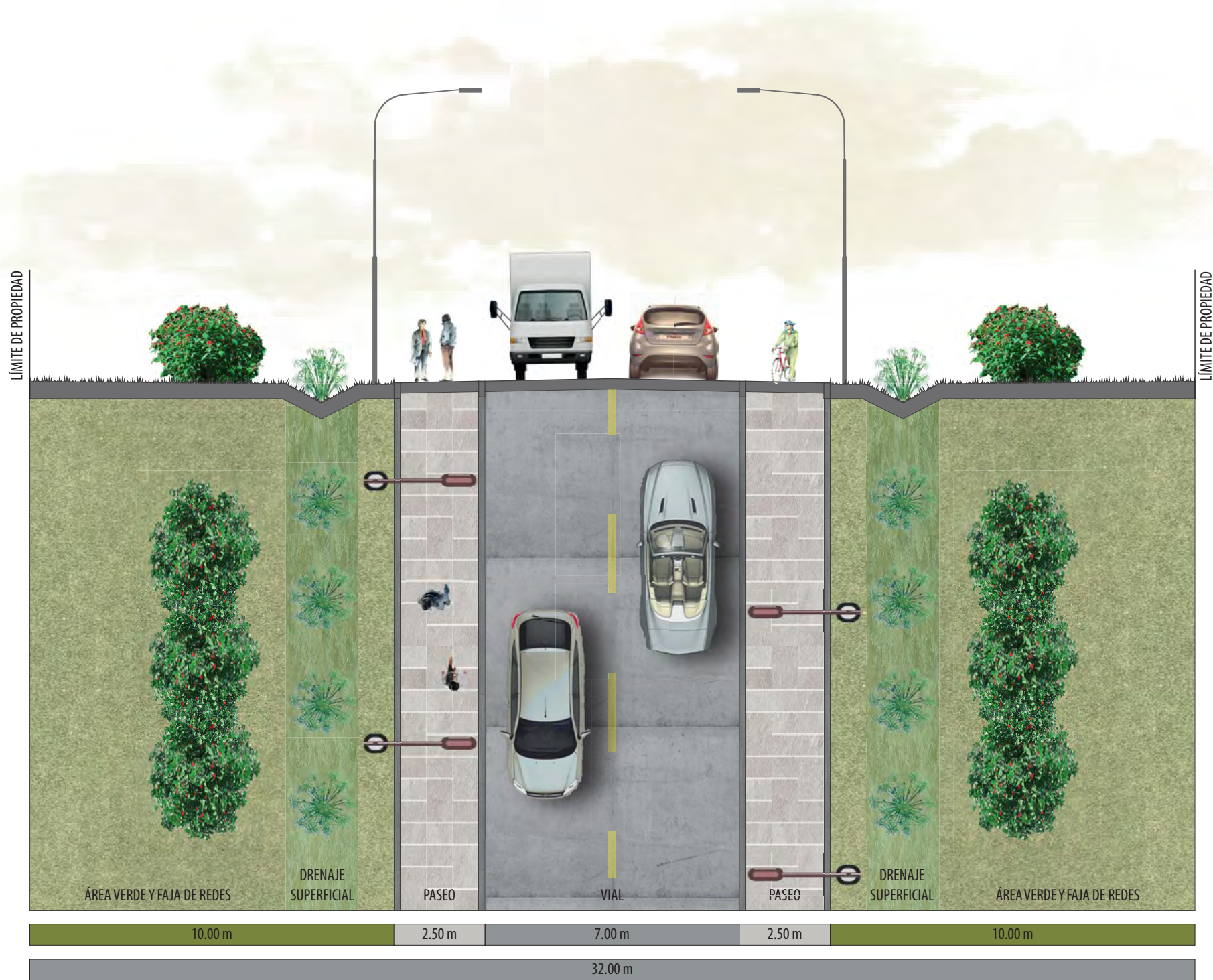
Figura 53. Viales secundarios. Planta y sección vial.
