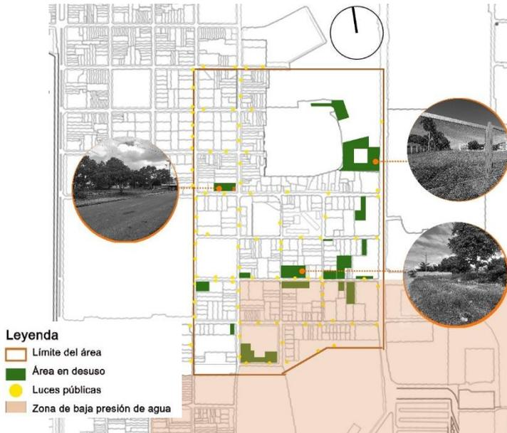
Como se aprecia en la Figura 40 el sur del área cuenta con una baja presión de agua, incluyendo las deficiencias hidrotécnicas y del drenaje existente en todo el Consejo Popular, el espacio se encuentra en un estado grave de infraestructura hidráulica.
